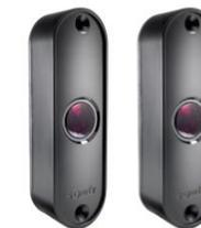
Il s'agit d'une paire de cellules à rayon infrarouge pour assurer la sécurité sur une installation de porte de garage motorisé en résidentiel. Elles permettent le contrôle des zones de mouvement de la porte de garage en évitant de se refermer sur un obstacle. La portée du rayon est de 10 mètres.
