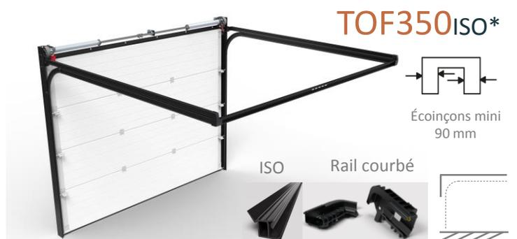
Le montage TOF350ISO nécessite une retombée de linteau minimum de **350** mm. Rails horizontaux surélevés de 150 mm par rapport au montage TOF200ISO.
