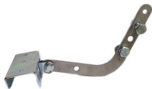
\*Conseillée pour les portes sectionnelles supérieures à 7m<sup>2</sup>, il permet de renforcer la prise de la section haute de votre porte afin d'éviter l'arrachement de celui-ci lors de l'ouverture/fermeture. Muni d'un bras coudé, il servira également à améliorer la poussée de votre porte en fermeture et d'affiner avec plus d'efficacité les réglages de vos fins de course.
