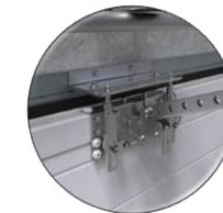
Ce dispositif renforce considérablement la sécurité de votre porte de garage. Positionné sur le panneau haut et couplé à votre motorisation, en fermeture, le verrouillage mécanique en 2 points s'effectuera grâce à la poussée du moteur et évitera aux cambrioleurs d'exercer une poussée sur la section haute et rendre votre installation plus sensible aux tentatives d'intrusion.
