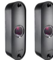
Il s'agit d'une paire de cellules à rayon infrarouge pour assurer la sécurité sur une installation de porte de garage motorisé en résidentiel. Elles permettent le contrôle des zones de mouvement de la porte de garage en évitant de se refermer sur un obstacle. La portée du rayon est de 10 mètres.
