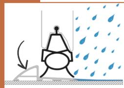
OPTION **SEUIL ALU ou EPDM** pour renforcer l'étanchéité au sol
