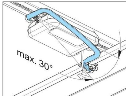
En inversant le montage du moteur, ce bras ALUTRL permet, sur les motorisations APERTO ou DUO VISION, de gagner environ 250 mm de refoulement. Tandis que pour les motorisations PRO/PRO+, le moteur n'est pas nécessaire d'être inversé grâce à une patte permettant de monter le bras ALUTRLPRO+ et gagner environ 200 mm de refoulement.
