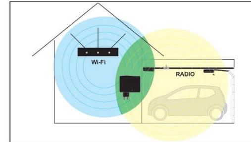
Le SOMweb doit donc être dans l'environnement du Wi-Fi et des récepteurs radio.
