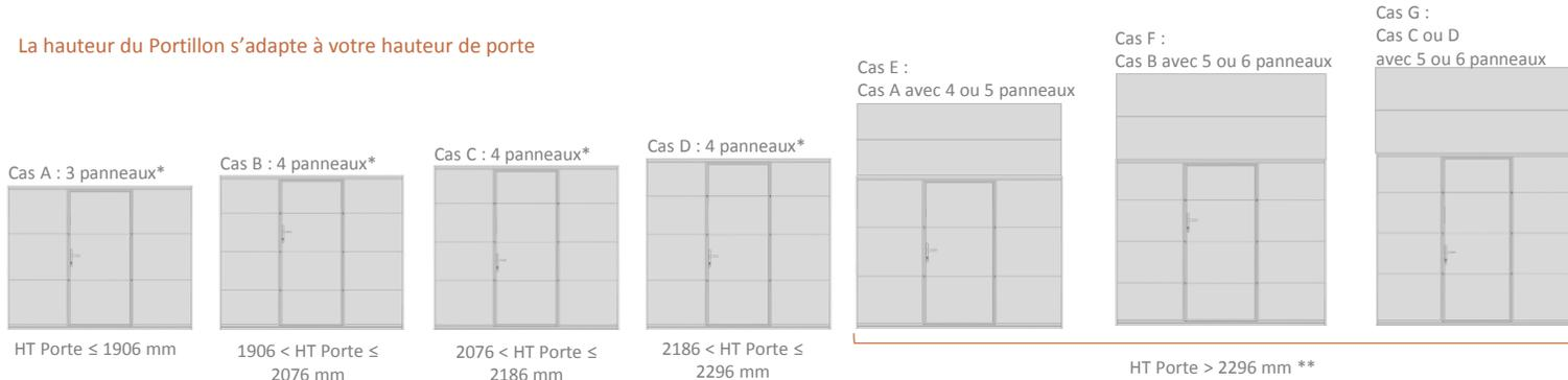
↑ ↓ Pour les cas A, B, C et D, la hauteur de passage libre dans le Portillon peut être définis par le calcul suivant : HT Porte – 100 mm
