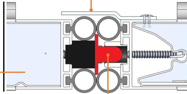
3 points de verrouillage sur la hauteur assurant la liaison en fermeture et une sécurité complémentaire.
