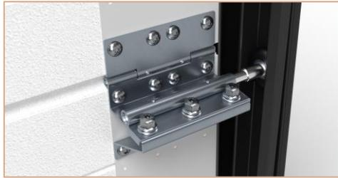
Pour les portes ayant une largeur  $\geq 5000$  mm, les charnières et roulettes simples sont doublées afin d'assurer la rigidité du tablier lorsque la porte est en mouvement et éviter l'usure précoce des roulettes.
