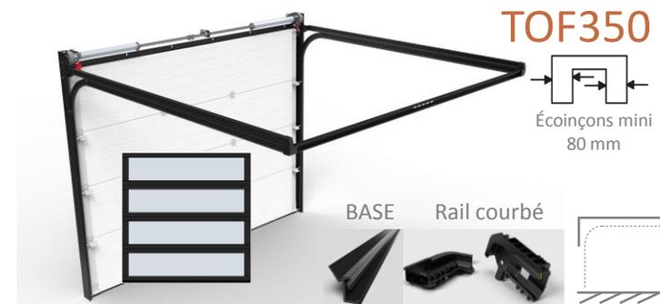
Le montage TOF350 nécessite une retombée de linteau minimum de **350** mm. Rails horizontaux surélevés de 150 mm par rapport au montage TOF200.
