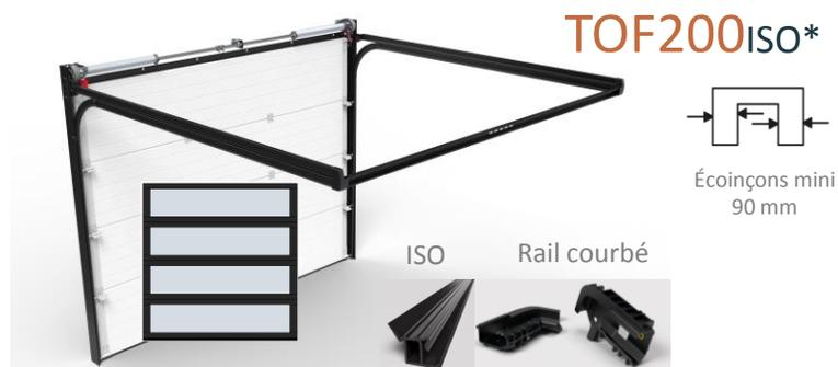
Le montage TOF200ISO nécessite une retombée de linteau minimum de **200** mm. Rails horizontaux surélevés de 35 mm.
