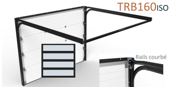
Le montage TRB160ISO nécessite une retombée de linteau minimum de **160 mm**. Rails horizontaux surélevés de 35 mm.
