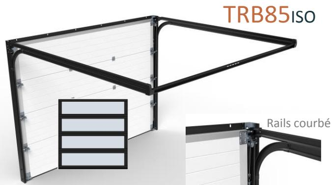
Le montage TRB85ISO nécessite une retombée de linteau minimum de **85 mm**, génère une perte de passage de 35 mm.
